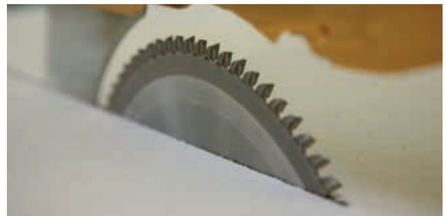
Bild Nr. 6: Geläufige Sägeblätter, geeignet für das Massivholz.
