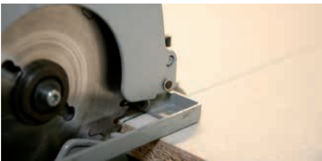
Bild Nr. 3: Zuschneiden mit der Handkreissäge.
