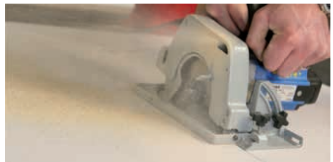
Bild Nr. 4: Kreissägeblatt-Vorschub ist kleiner im Gegensatz zu der Massivholzbearbeitung.
